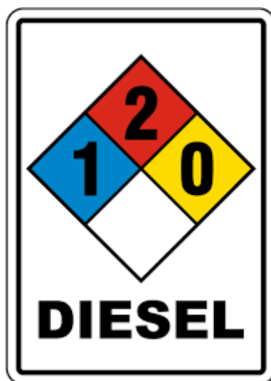
Figura 3. Rombo de Seguridad de Diésel.
